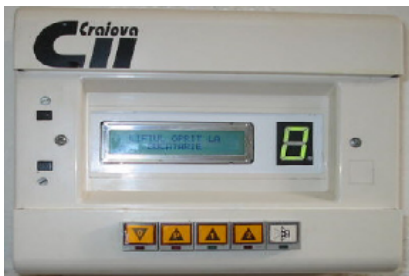
Fig.1.17. Partea informațională a schemei de comandă și vedere de ansamblu a produsului MICROAS.
