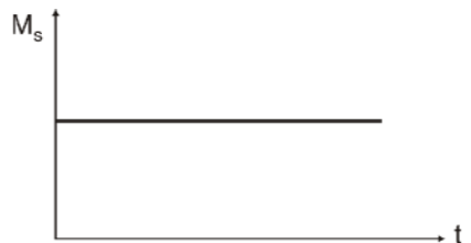
Fig.2.16. Diagrama cuplului static pentru regimul de durată cu sarcină constantă
